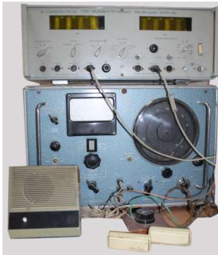
Рис. 14. Установка для вимірювання латентного періоду аудіо-моторної реакції
